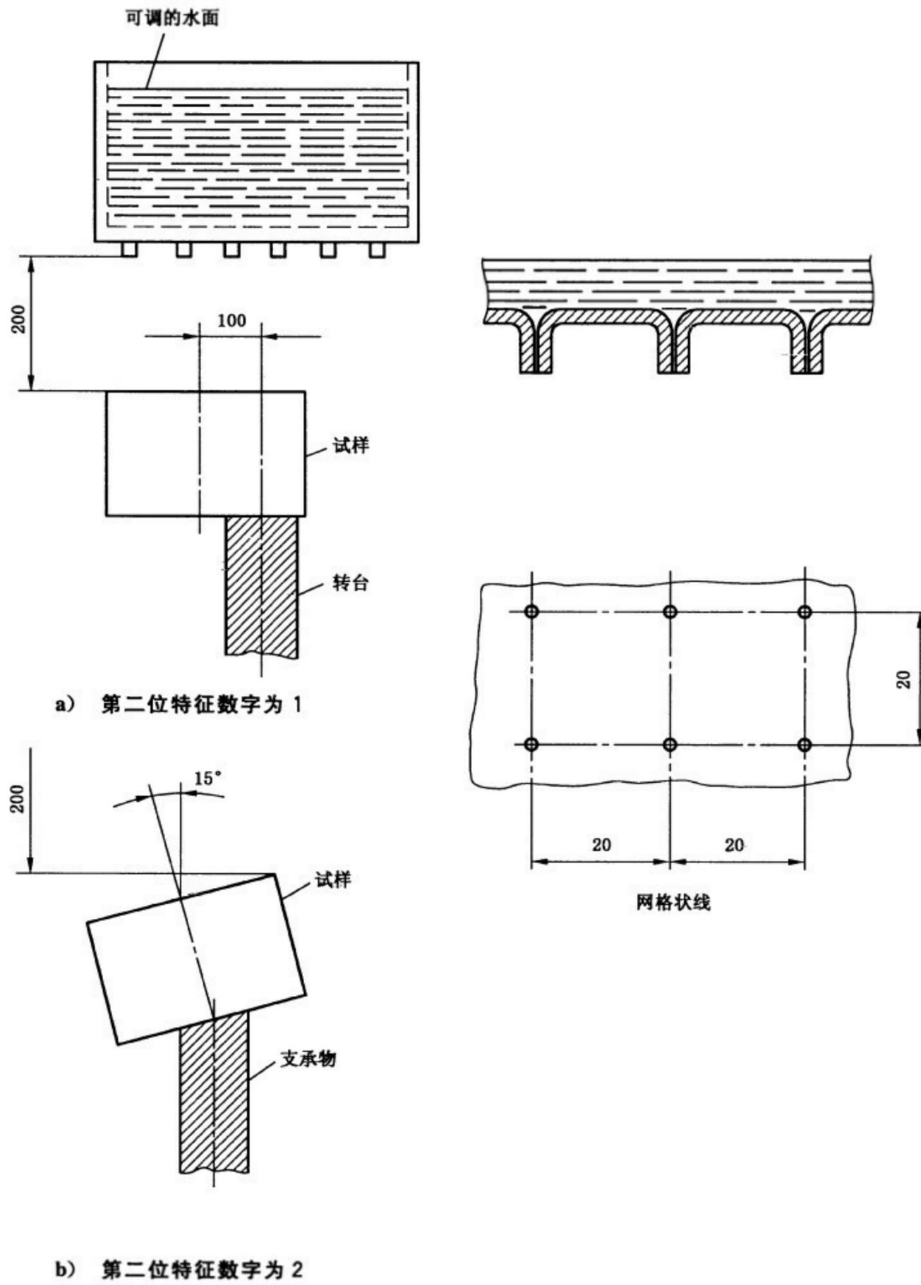
图 3 检验防垂直滴水试验装置(滴水箱)
